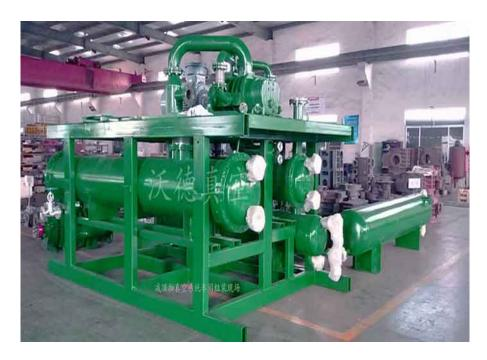
真空泵在安装时有哪些要求真空泵是常见的真空设备,那么,真空泵在安装时有哪些要求呢?真空泵在 其工作压强下,应能排走真空设备工艺过程中产生的全部气体量。正确地组合真空泵。由于真空泵有选择性抽 气,因而,有时选用一种泵不能满足抽气要求,需要几种泵组合起来,互相补充才能满足抽气要求。如钛升华 泵对氢有很高的抽速,但不能抽氦,而三极型溅射离子泵,(或二极型非对称阴极溅射离子泵)对氩有一定的抽 速,两者组合起来,便会使真空装置得到较好的真空度。真空泵不能在大气压下工作,需要预真空,有的真空 泵出口压强低于大气压,需要前级泵,故都需要把泵组合起来使用。真空设备对油污染的要求。若设备严格要 求无油时,应该选各种无油泵,如:水环泵、分子筛吸附泵、溅射离子泵、低温泵等。如果要求不严格,可以 选择有油泵,加上一些防油污染措施,如加冷阱、障板、挡油阱等,也能达到清洁真空要求。真空泵应安装在 地面结实坚固的场所,周围应留有充分的余地,便于检查、维护、保养。真空泵底座下应保持地基水平,底座 四角处建议垫减震橡皮或用螺栓浇制安装,确保真空泵运转平稳,振动小。真空泵与系统的连接管道应密封可 靠。
