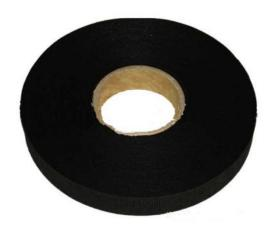
绝缘纸俗称菱格点胶纸,菱格纸,英文缩写为DDP①是以电缆纸为底材,将特种改性环氧树脂呈菱格状涂覆在电缆纸上而成的一种绝缘材料。将特种改性环氧树脂呈菱格状在电工绝缘纸上的绝缘材料。产品普遍地应用于油浸式电力变压器的层间绝缘及匝间绝缘,使用时涂覆层在线圈干燥过程中在一定温度时开始熔化,产生粘附作用,随着温度的升高又开始固化,使绕组的相邻各层可靠地粘合成一个固定单位。环氧树脂的粘合强度足以防止短路时绕组各层的位移,从而保证了绝缘结构长的电气和力学性能。产品特性:使线圈有非常好的抗轴向短路应力的能力;提高线圈的对热和力的抗冲击能力,有利于变压器的寿命和可靠性;产品用途:适用于油浸式电力变压器的匝间绝缘,及配电电压器线圈的层间绝缘。点胶纸普遍的应用于油浸式电力变压器的层间绝缘及匝间绝缘,使用时涂层在线圈干燥过程中在一定温度时开始溶化,产生粘附作用。随着温度的升高又开始固化,使绕组的相邻各层可靠在粘合在一个固定的单元。环氧树脂的粘合强度足以防止短路时绕组各层的位移,从而保证了绝缘结构长期的机械电气性。由于菱格点胶纸的树脂涂层呈点状,保证了油的浸入和绝缘材料中气体的排出,有效地避免电晕和局放。
